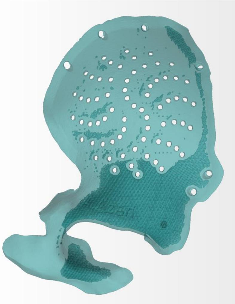
Eingebrachte Gitterstruktur mit Pulverrückständen kontaminiert
