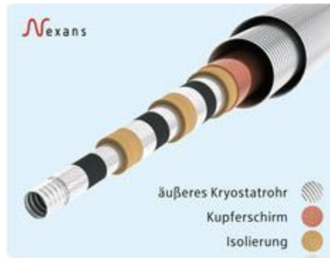
Aufbau eines supraleitenden Kabels
