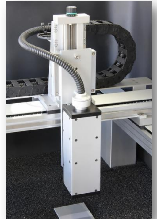
Messmodul montiert auf XY-Scanner
